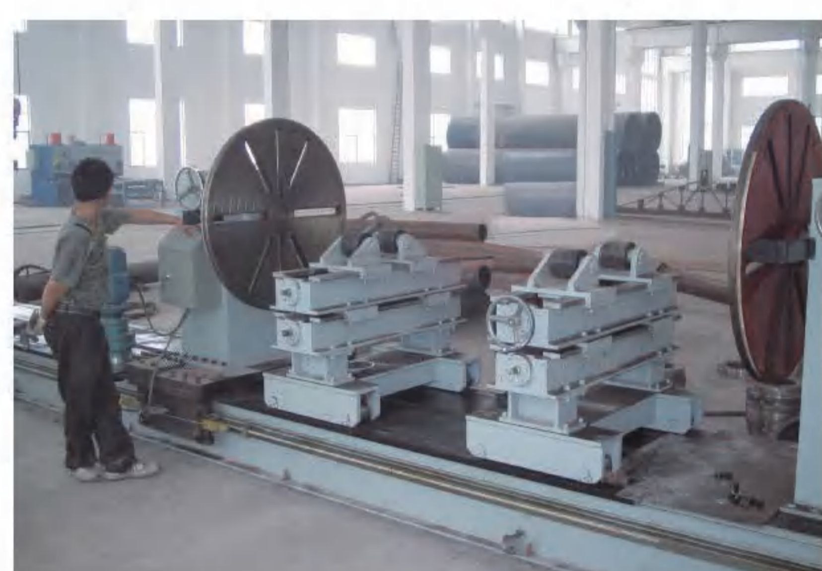
法兰焊接专机 Flange welding machine
